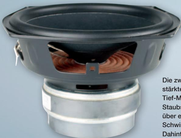
Die zweilagige, Aramid-verstärkte Faser-Membran der Tief-Mitteltöner kommt ohne Staubschutzkappe aus. Sie ist über einen Subkonus mit der Schwingspule verbunden. Dahinter sitzt ein Ferrit-Magnet.
